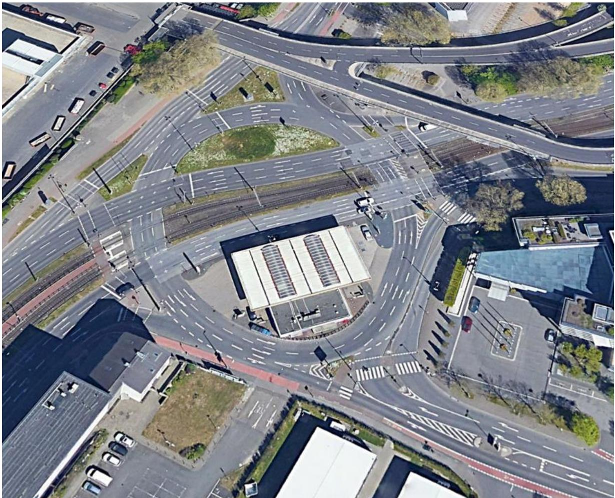
Abbildung 7.11: Beispiel eines komplex signalisierten Kreisverkehrs in Köln (Messekreisel)
